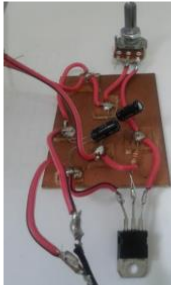
Figura 3: Regulador de tensão feito por aluno. Fonte: Autor.
