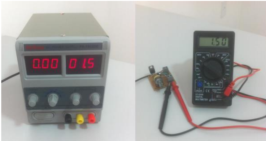
Figura 2: À esquerda a fonte de tensão de bancada (0~15V), na direita o controlador de tensão (1,5~12V) feito pelo autor, ambos controlados linearmente por um potenciômetro, mostram a mesma voltagem 1,5 V. Fonte: Elaborado pelo autor.
