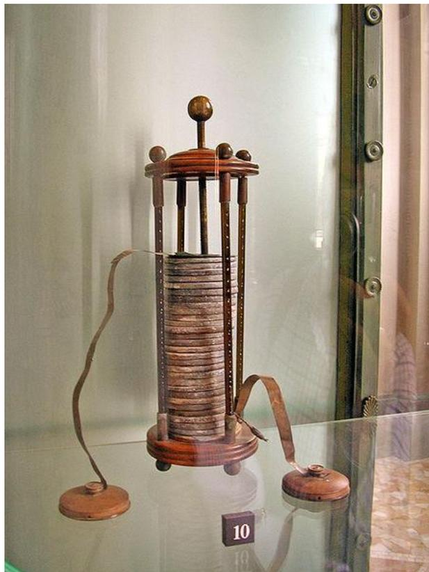
Figura 3: Pilha de Volta, discos de Cu e Zn empilhados e embebidos em uma solução ácida.
